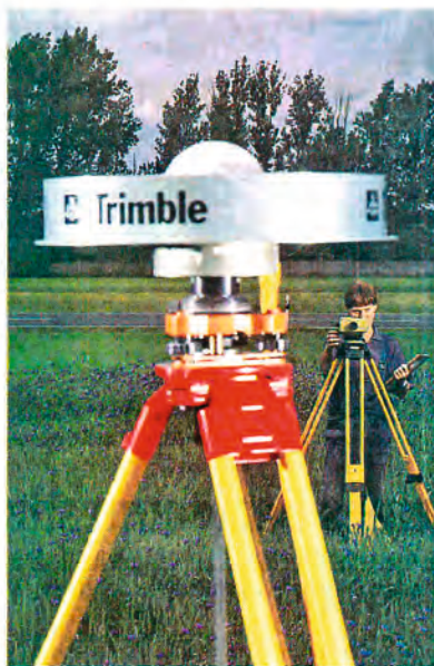
„Nachts ein ziemlich einsamer Job“: Vermessungsingenieur Peter Harnisch hat über dem geodätischen Messpunkt in einem Feld bei Bautzen eine Satellitenantenne installiert. 24 Stunden lang wird sie – bewacht – Signale empfangen, die die Koordinaten des Messpunkts künftig millimetergenau präzisieren. Foto: privat/Blatt
