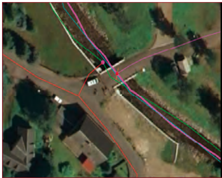
Die Grafiken zeigen die mangelnde Passfähigkeit aktueller Geodaten im Grenzbereich der hinteren Sächsischen Schweiz, unterschiedliche deutsch-tschechische Grenzverläufe und Straßen bzw. Wege, die nach der Grenze nicht fortgeführt werden
